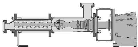
Насосы серии MDTC оснащены загрузочной воронкой с цилиндрической / конической зоной сжатия. Транспортируемая среда с низкой текучестью или не обладающая текучестью подается с помощью транспортного шнека на соединительной штанге к транспортирующим элементам – ротору и статору. Оптимальная загрузка транспортировочных камер достигается за счет давления подкачки в зоне сжатия. Насосы серии MDTC оснащены открытыми шарнирами серии MDC и соответствуют нормам санитарного стандарта США ЗА.
