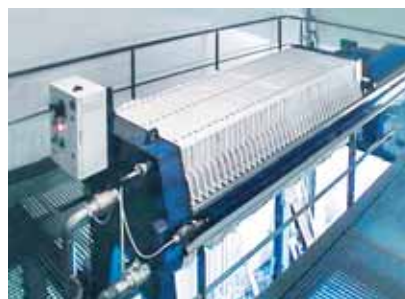
При помощи системы управления seerex FPPU достигается оптимальная загрузка фильтр-пресса эксцентриковыми шнековыми насосами seerex .
