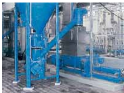
Насосы сеерех VTI 17-24. Продукт: обезвоженный шлам из центрифуги с примерно 30% сухого остатка. Особенность: Шлам обрабатывается в насосе известью и далее перерабатывается в сельском хозяйстве.
