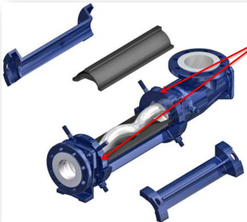
1. 2 сегмента крепёжных колец для позиционирования статора и юстировочных элементов.
