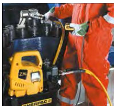
◀ Переносные насосы серии ZU4T могут быть использованы для подачи давления на гидравлические моментные ключи любой модели.
