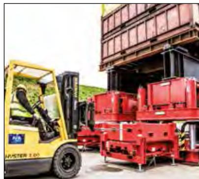
▼ Установленные один на другой опорные блоки обеспечивают механическое удерживание груза
