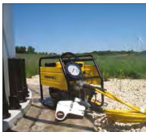
Насос TQ-700E и гайковерты серии W – эффективная комбинация для обслуживания ветроэнергетических установок.
