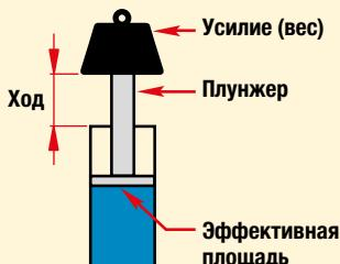
$$\begin{array}{l} \text{Усилие} = \text{Рабочее давление в гидросистеме} \times \text{Эффективная площадь цилиндра} \\ F = P \times A \end{array}$$
