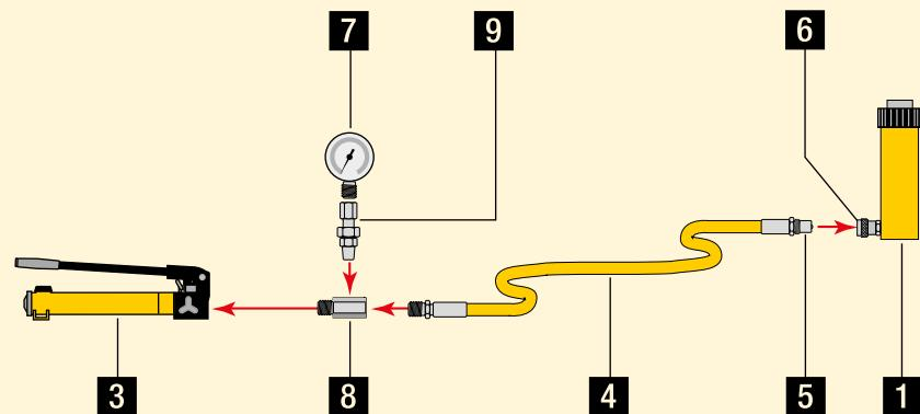
Цилиндр одностороннего действия с большим ходом штока используется для подъема грузов.
