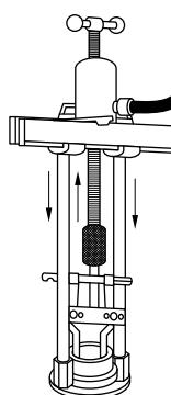
◀ Показан съемник для снятия обойм подшипников, подсоединененный к съемнику-хомуту.
