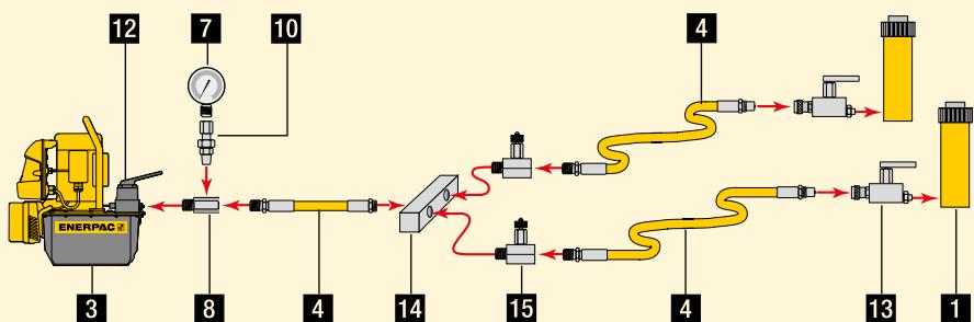
**Подъемная система с четырьмя подъемными точками с использованием цилиндров одностороннего действия и клапанов управления.**
