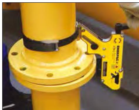
**Удобный и безопасный инструмент для быстрого выравнивания соосности фланцев.**
