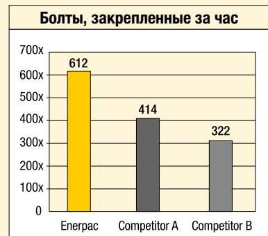
Внутренне лабораторное испытание на основе стандартного процесса вращения на фланце трубы - 14 шт. болтов 1½".
