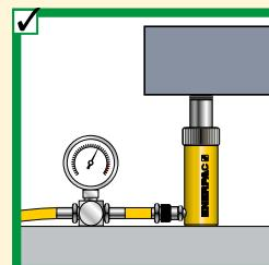
Не превышайте установленные на заводе настройки предохранительных клапанов. Всегда пользуйтесь манометрами для контроля давления в системе.
