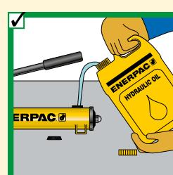
Используйте только масло Enerpac. Неподходящая жидкость может испортить уплотнения и насос и гарантия на оборудование Enerpac будет аннулирована.
