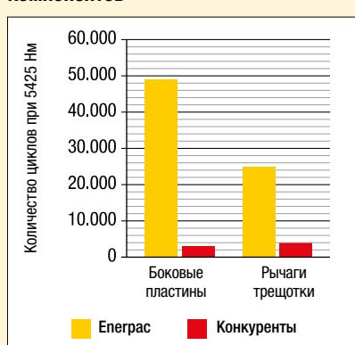
\* Усредненные результаты испытаний, в которых три 46-мм кассеты UltraSlim Enerpac и три 46-мм кассеты основных конкурентов тестились при крутящем моменте 5425 Нм в течение 50.000 циклов. Боковые пластины кассет Enerpac ни разу не сломались в процессе испытаний.
