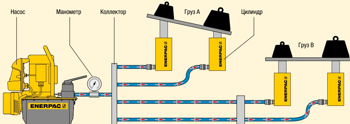
Системы синхронного подъема или клапаны управления обеспечивают равномерный подъем грузов.
