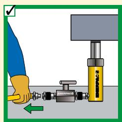
Отсоединяйте цилиндры только если они полностью возвращены или используйте отсечные клапаны, чтобы зафиксировать давление в цилиндре.
