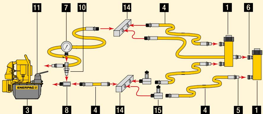
**Подъемная система с двумя подъемными точками с использованием цилиндров одностороннего действия.**
