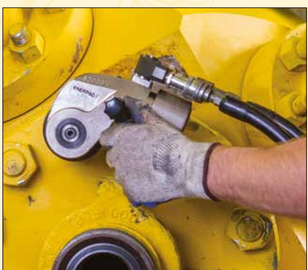
**Применение гайковерта S3000X при техобслуживании нефтегазового оборудования**
