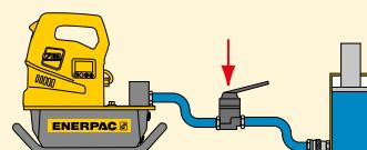
Клапаны могут быть электромагнитными или с ручным управлением.
