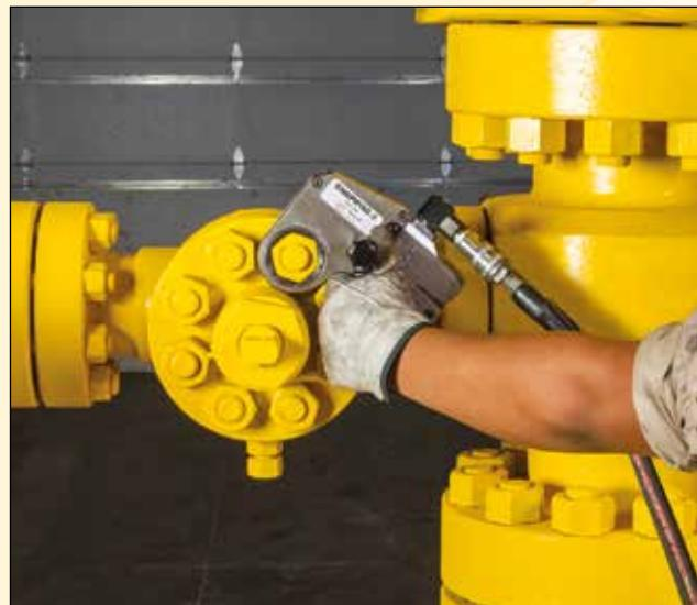
**Применение низкопрофильного гайковерта W4000X для затягивания болтов на трубных фланцах стандарта API**
