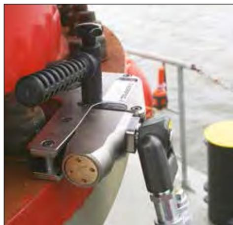
◀ Простое и надежное обслуживание и ремонт в условиях мастерских с использованием стальных ключей Enerpac, работающих от пневматического гидронасоса для моментных ключей.
