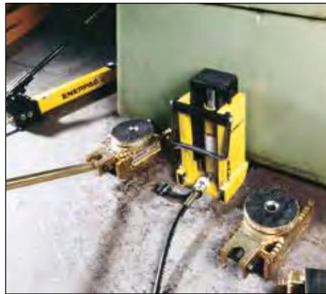
▼ Перевозка резервуара для химиков: Первые несколько сантиметров подъема были достигнуты при помощи низкопрофильных цилиндров серии RCS, после чего груз был передвинут на тележки для перевозки.
