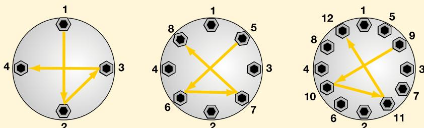
**Шаг 1** Болты затягиваются гаечным ключом до тех пор, пока над гайкой не появится 2-3 витка резьбы.
