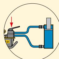
Клапаны могут быть внешними или установленными на насосе.
