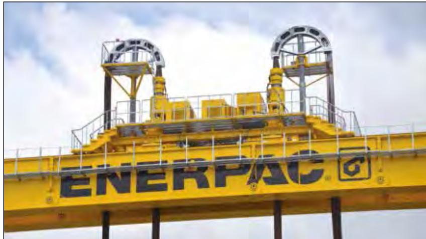
◀ Система тросовых домкратов HSL85007 в разработанном на заказ самонесущим порталом кране Enerpac.
