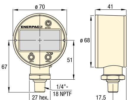
▼ Повышенная точность и удобство считывания показаний: повышает возможности мониторинга и контроля давления в гидравлической системе при давлениях до 1380 бар.
